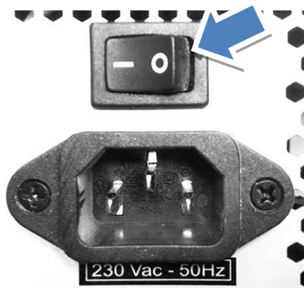
Fig. 6 – Dettaglio Presa Rete Alimentazione con interruttore
